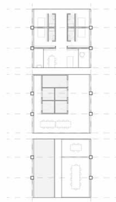
Une trame structurale permettant la réversibilité des espaces
